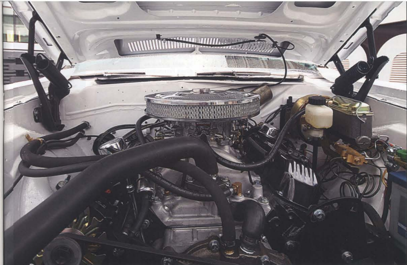
Unter der Haube arbeitet ein Chrysler LA 360 Smallblock Stroker mit 408 ci
